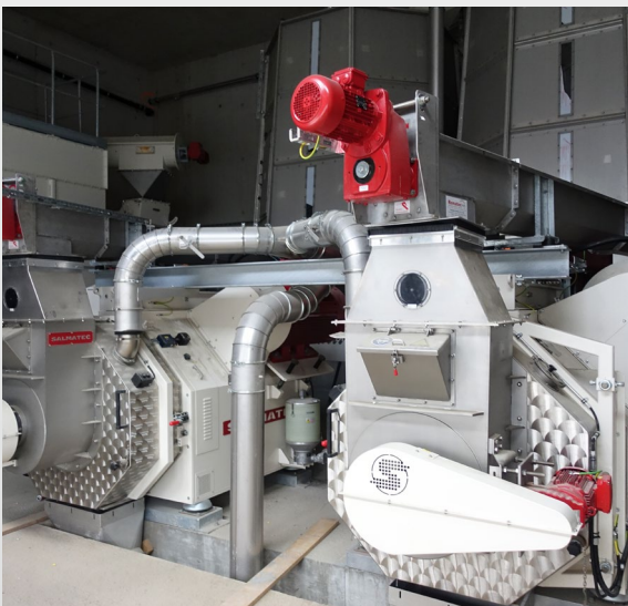
In der Matrize wird das Sägemehl unter Druck zu Pellets verarbeitet.
